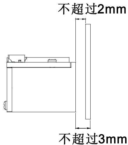
若窗口需倾斜设计，距离的要求与平行安装相同，倾斜角度应保证没有可反射入镜头的各种光束，以保证识读性能。
