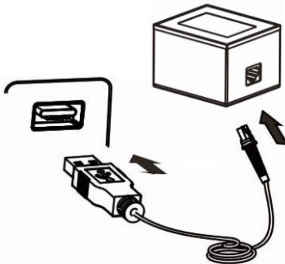
1. 将 USB 数据线的设备接口端（RJ45 接口）与 FR20 相连；
