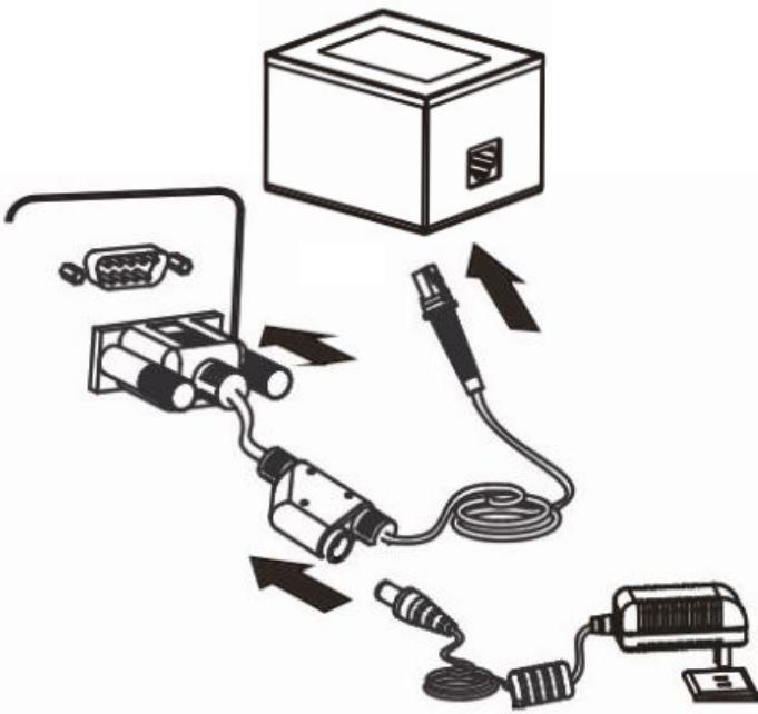
1. 将 RS-232 数据线的设备接口端（RJ 45 接口）与 FR20 相连；
