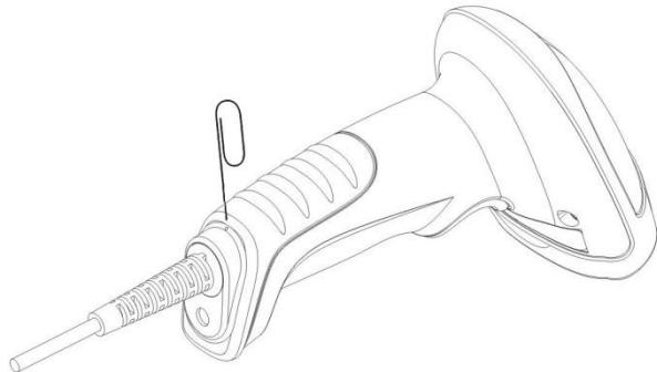
将已经连接在 HR32 有线枪上的通讯数据线去除，需要一根大小与枪体上的拆卸孔相适合的针状物（如回形针）作为辅助工具，如上图所示，将回形针的一端拉直以便插进拆卸孔。剩余操作步骤为：
