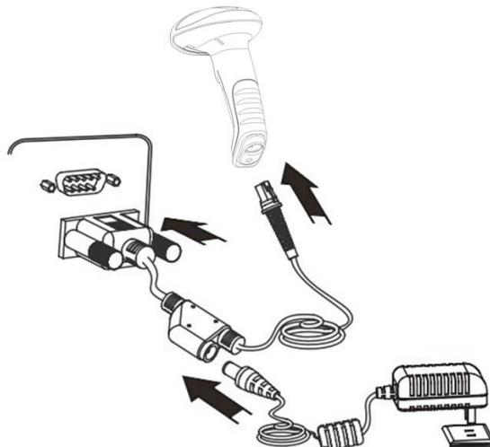
1. 将 RS-232 数据线的设备接口端（RJ 45 接口）与 HR32 相连；
