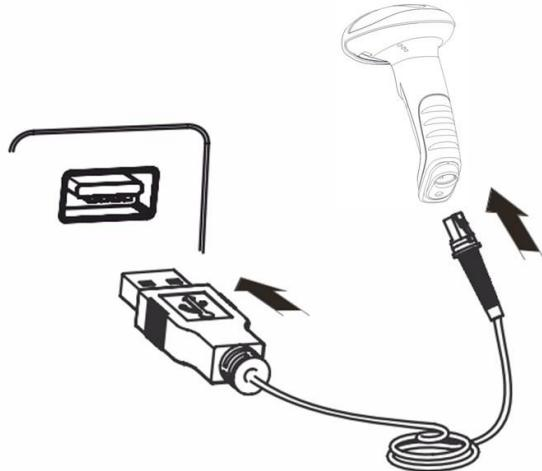
1. 将 USB 数据线的设备接口端（RJ45 接口）与 HR32 相连；
