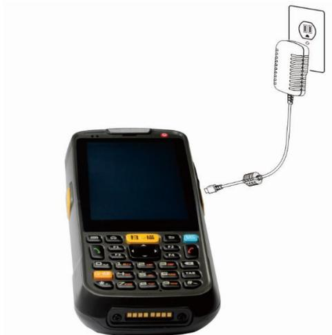
注：NLS-MT60 电力不足容易造成误动作，第一次使用时请先充电至少 5 小时，以确定 NLS-MT60 电池已充饱后再进行使用。
