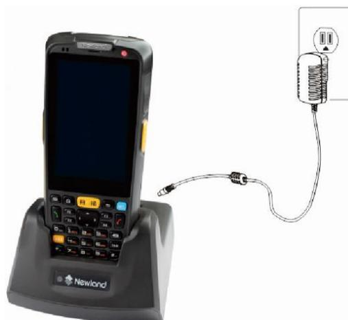
注意：充电期间，如通过底座与电脑通讯，通讯完成请移除 USB 线，并将 NLS-MT60 拿起重新插入底座，否则充电速度将变慢。
