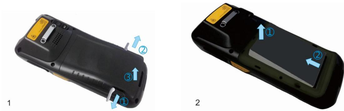
步骤 1：按住电源按键不动约 5 秒后关机，拆掉手腕带，先将电池后盖锁扣向外掰开至图示位置，取下电池后盖。
