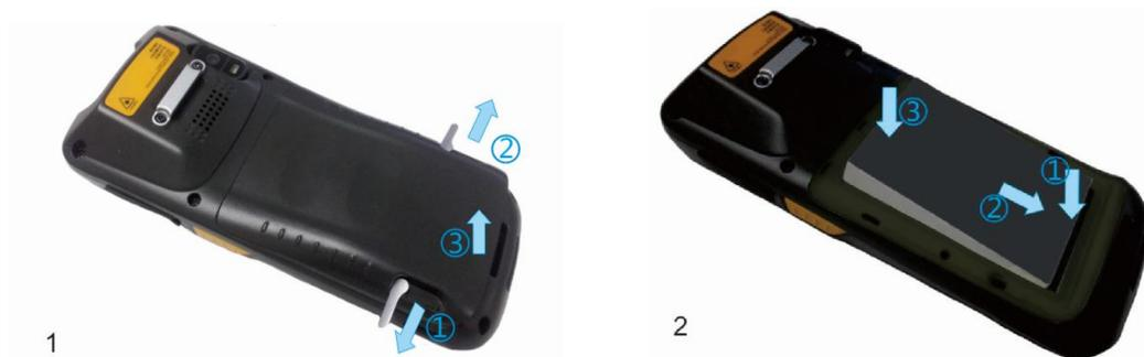
步骤 1：置入电池时，先将电池后盖锁扣向外掰开至图示位置，取下电池后盖。
