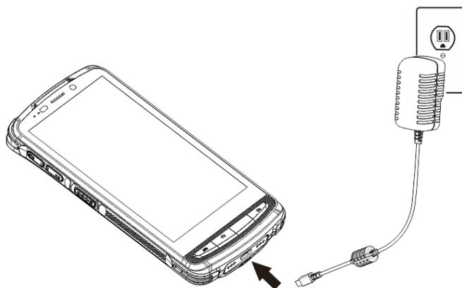
注意：MT90 电力不足容易造成误动作，第一次使用时请先充电至少 6 小时，以确定 MT90 电池已充饱后再进行使用。
