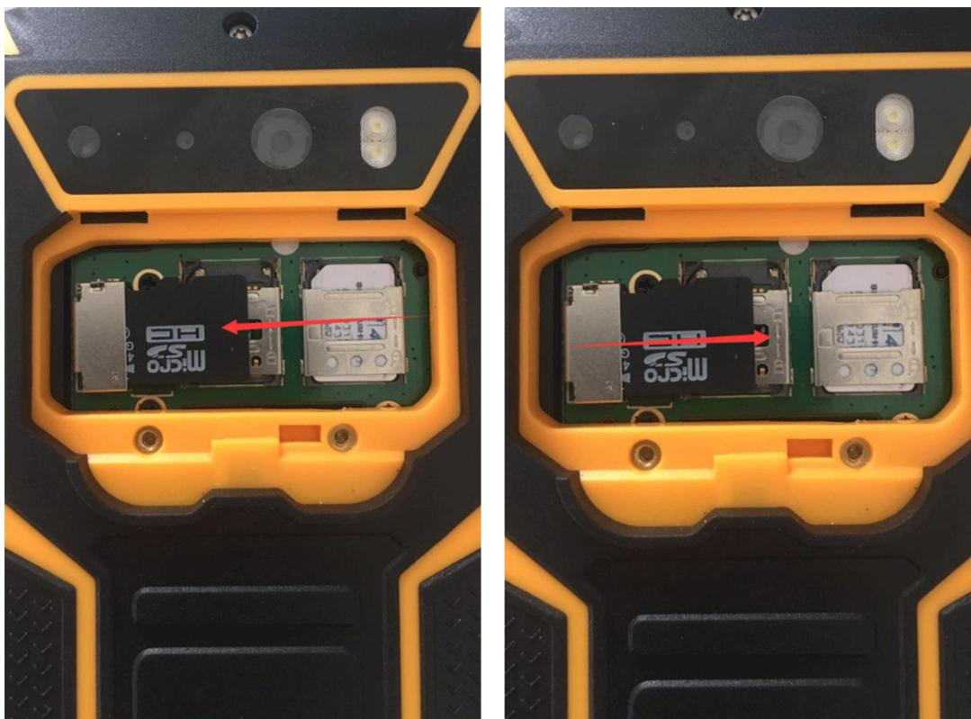
图 2.5-1 移除 T-flash 卡示意图
