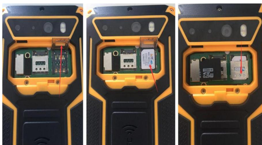
图 2.4-2 N7000R SIM 卡安装示意图
