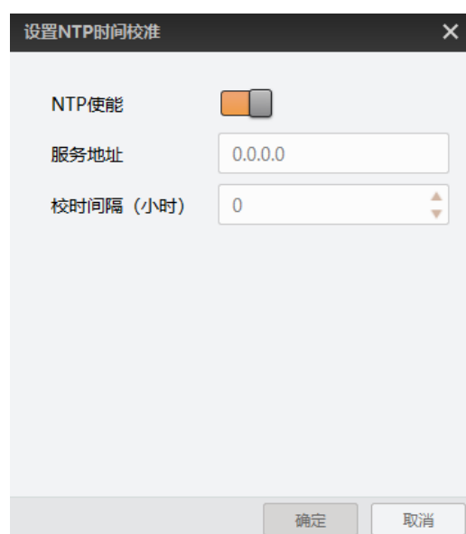
图3-94 NTP 时间校准设置
