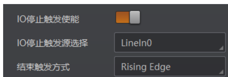
图3-56 I/O 外触发停止
