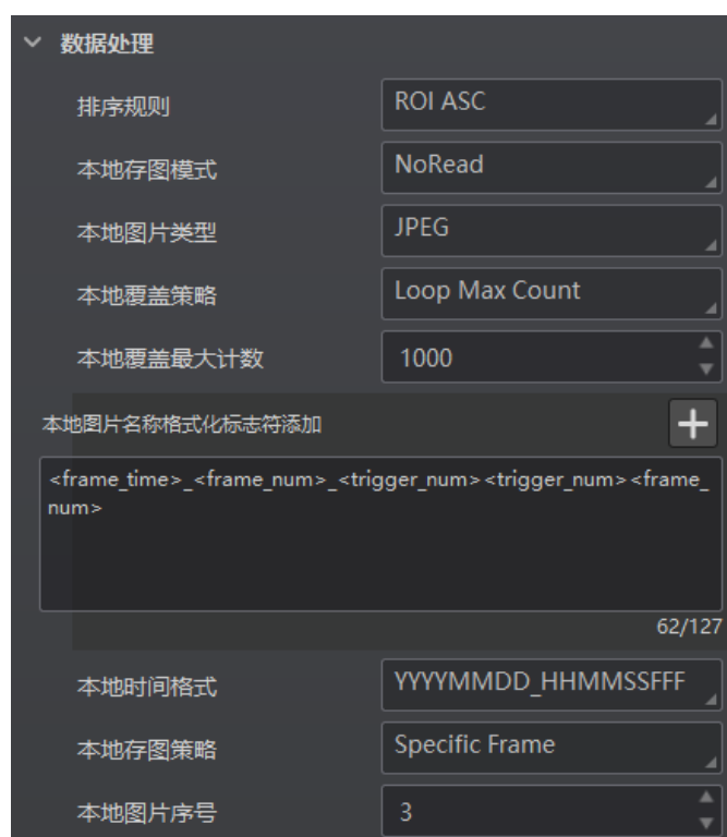
图3-75 SmartSDK 协议的数据处理
