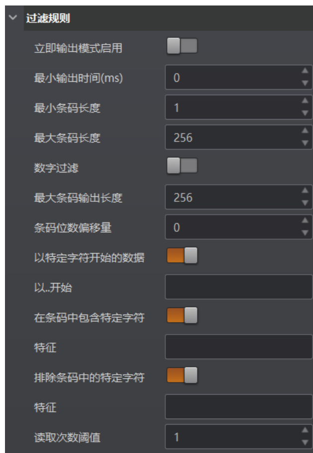
图3-71 普通过滤模式过滤规则参数
