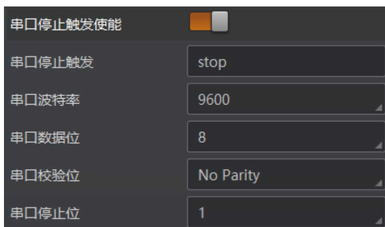
图3-58 串口停止触发
