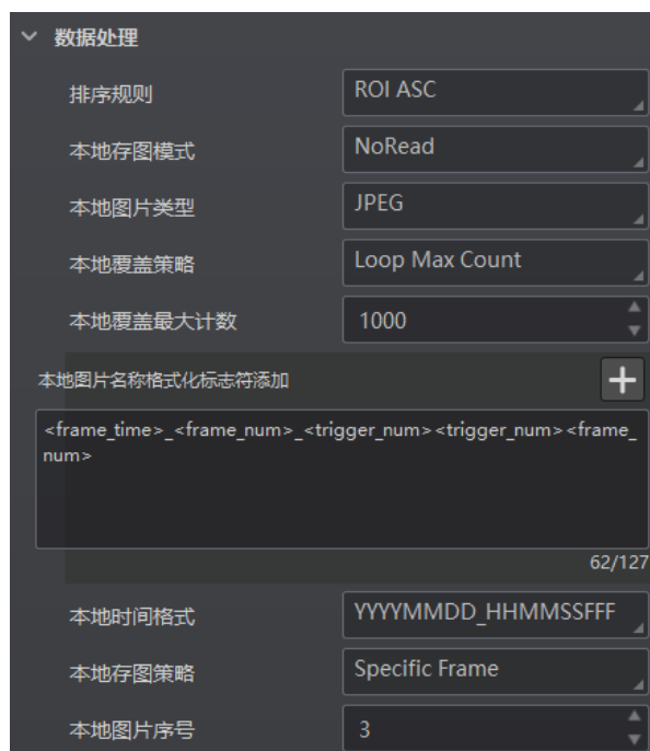
图4-96 SmartSDK 协议的数据处理
