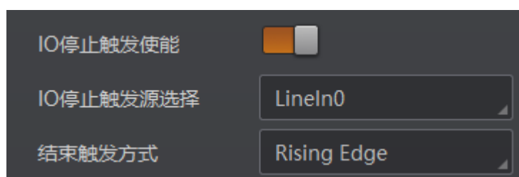
图4-60 I/O 外触发停止
