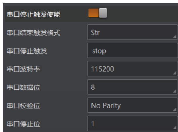
图4-62 串口停止触发
