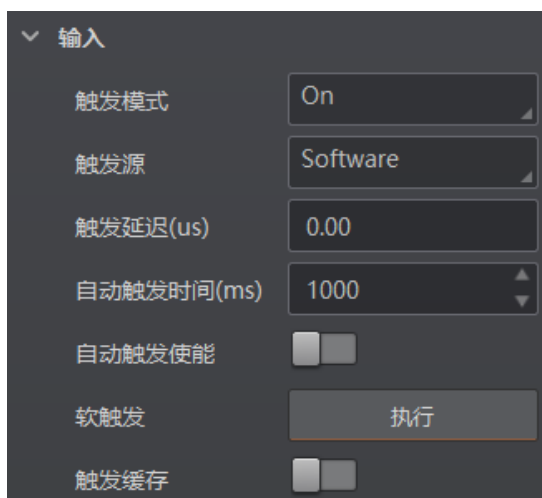
图4-47 软触发参数设置
