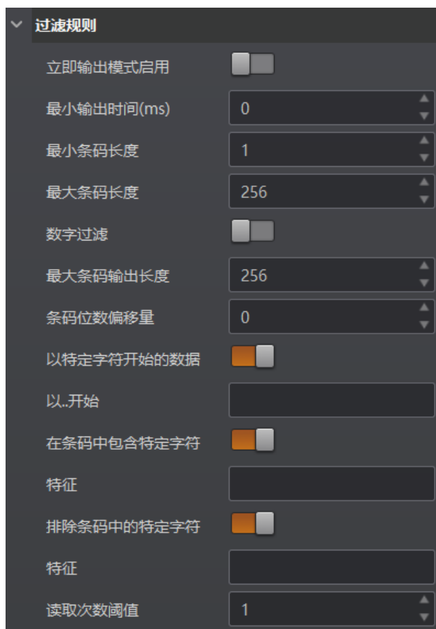
图4-89 普通过滤模式过滤规则参数
