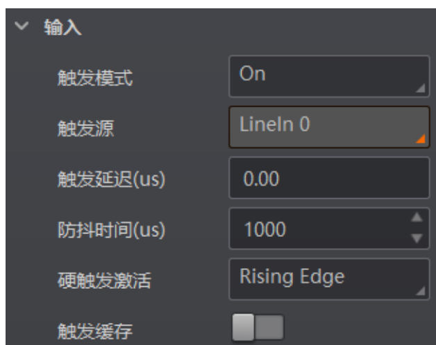
图4-48 外部触发参数设置
