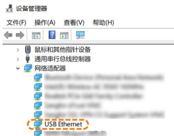
图3-10 驱动安装正常
