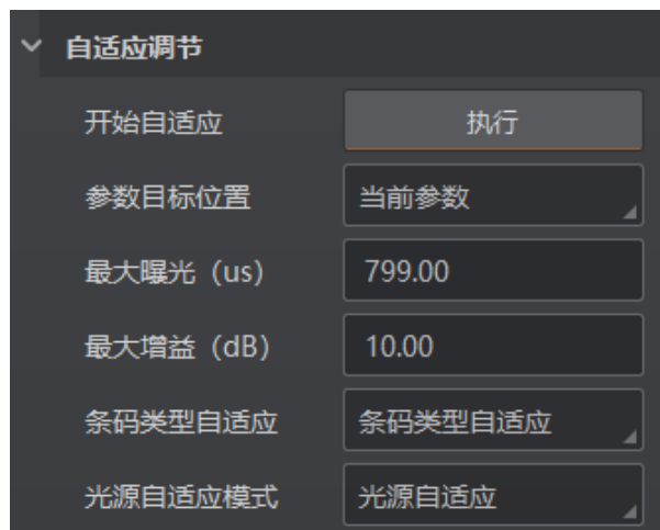
图4-23 自适应调整参数
