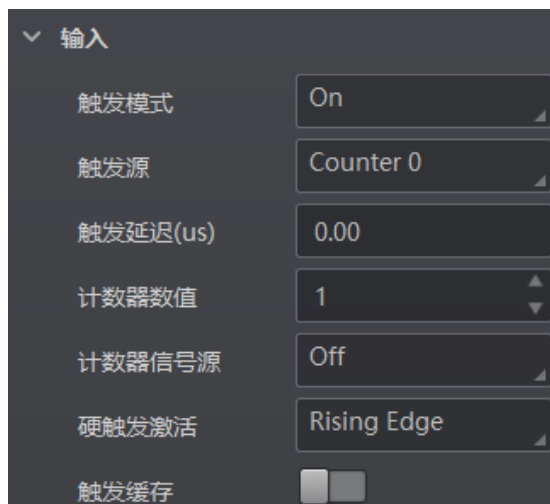
图4-51 计数器触发参数设置
