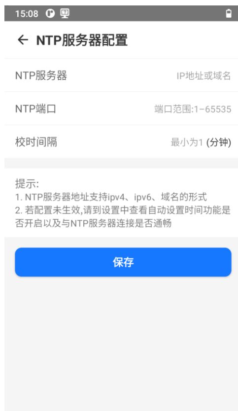
图4-5 配置 NTP 服务器
