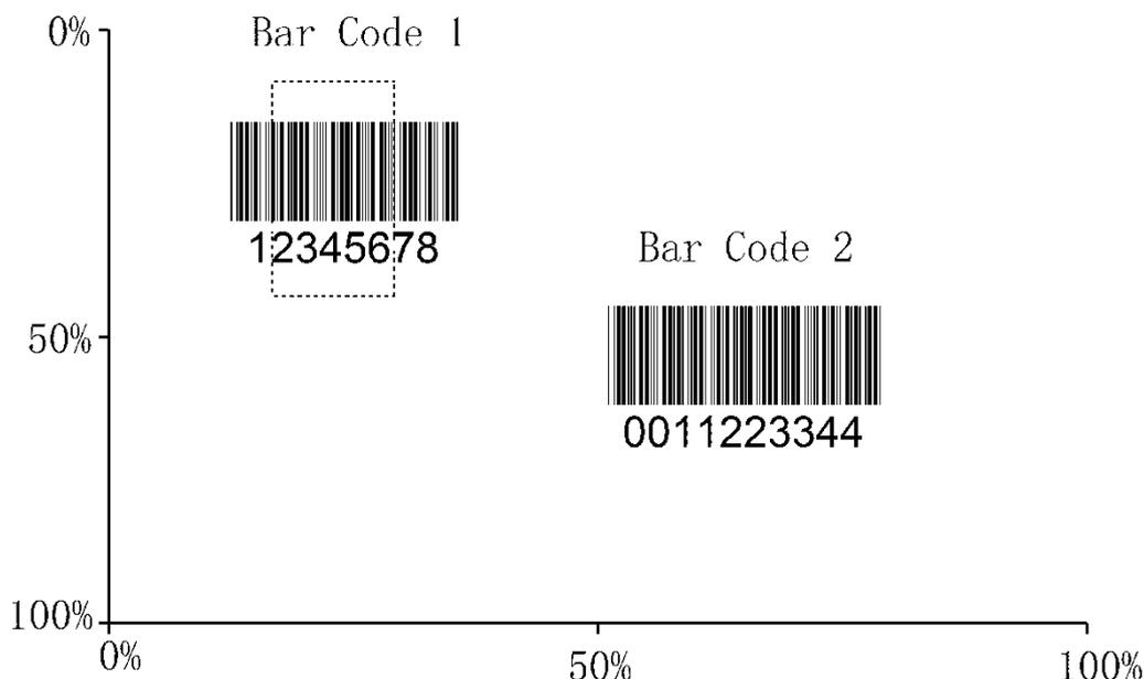
举例，设置只识读上图中的 Bar Code 1，中心区域的顶部为 10，底部为 45，左侧为 15，右侧为 30，可以按顺序识读以下条码来设置：
